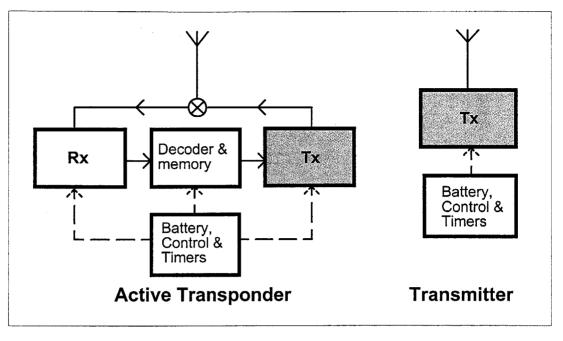
FIGURE 1. COMPONENTS OF A SIMPLE RADIO ACTIVE TRANSPONDER SHOWING TRANSMITTER (Tx), ADDITIONAL RECEIVER (Rx), DECODER AND A WILDLIFE TRANSMITTER.
